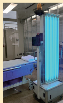
紫外線を照射して除菌作業を行う機器
